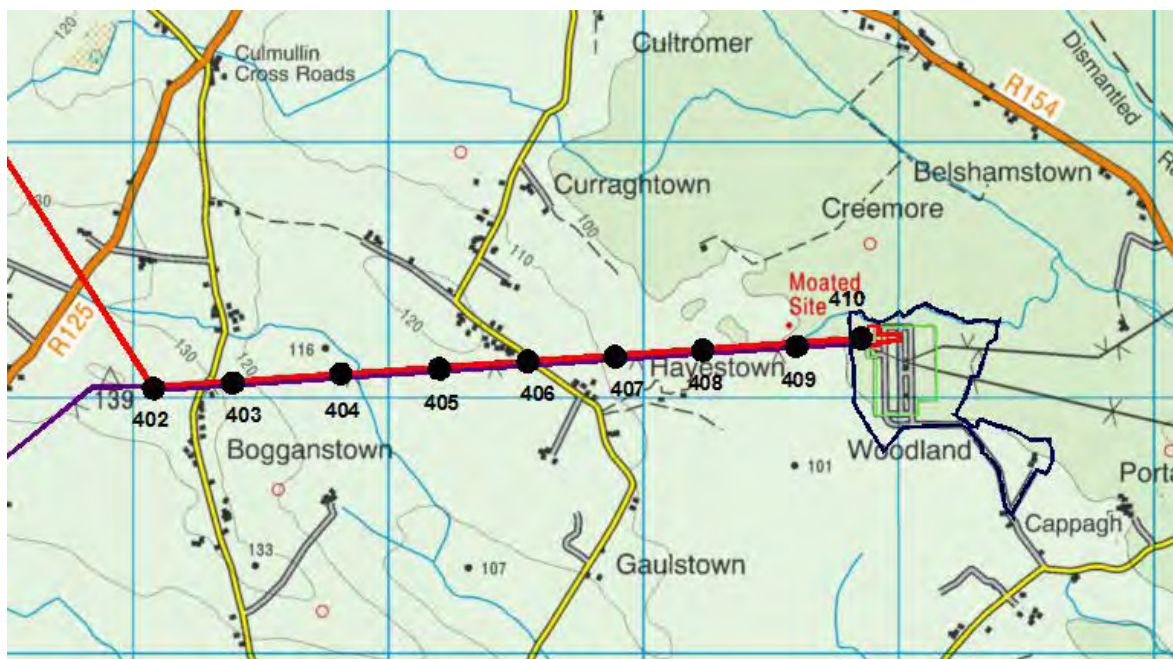
Fíor 2.6: Ciorcad Nua a Chur leis feadh Thúr 402 go Túr 410 den líne lasnairde 400 kV atá ann cheana idir an tSeansráid agus Fearann na Coille i Limistéar Staidéir na Mí (MSA)
